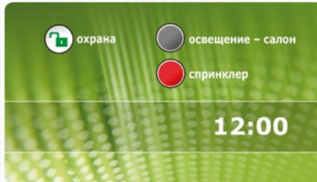
Клавиатура **INT-TSG** обеспечивает простой и быстрый доступ к информации о текущем состоянии системы. Благодаря возможности настройки информации, отображаемой на дисплее в режиме заставки, хватит одного взгляда на экран устройства, чтобы понять, поставлена ли система на охрану, включено ли наружное освещение или, например, работает ли в данный момент система полива газонов.
